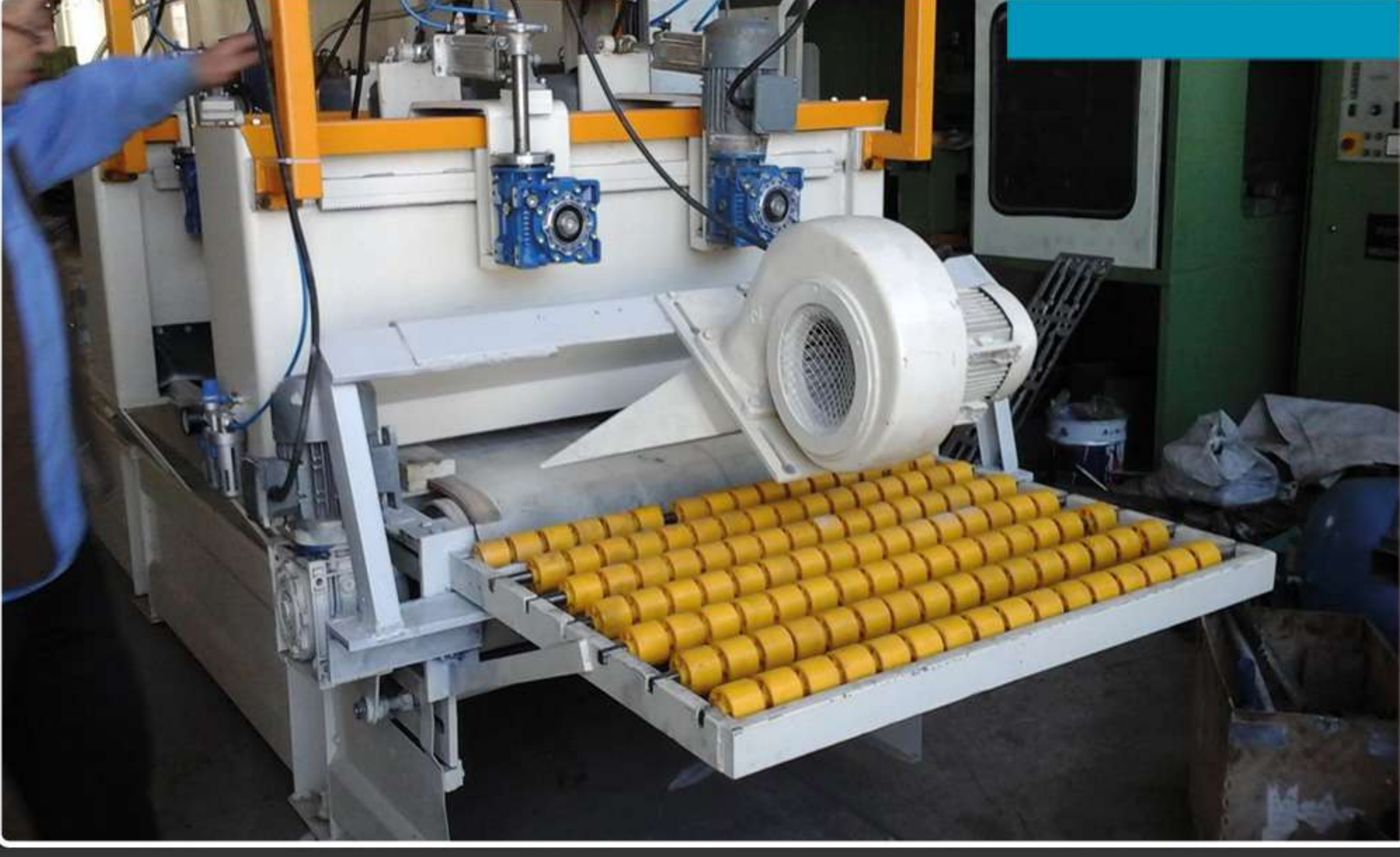
Trimming Ebatlama Makinesi Maximum 650 mm Mermer kalınlığı 80 mm Motor gücü 7,5 kw
