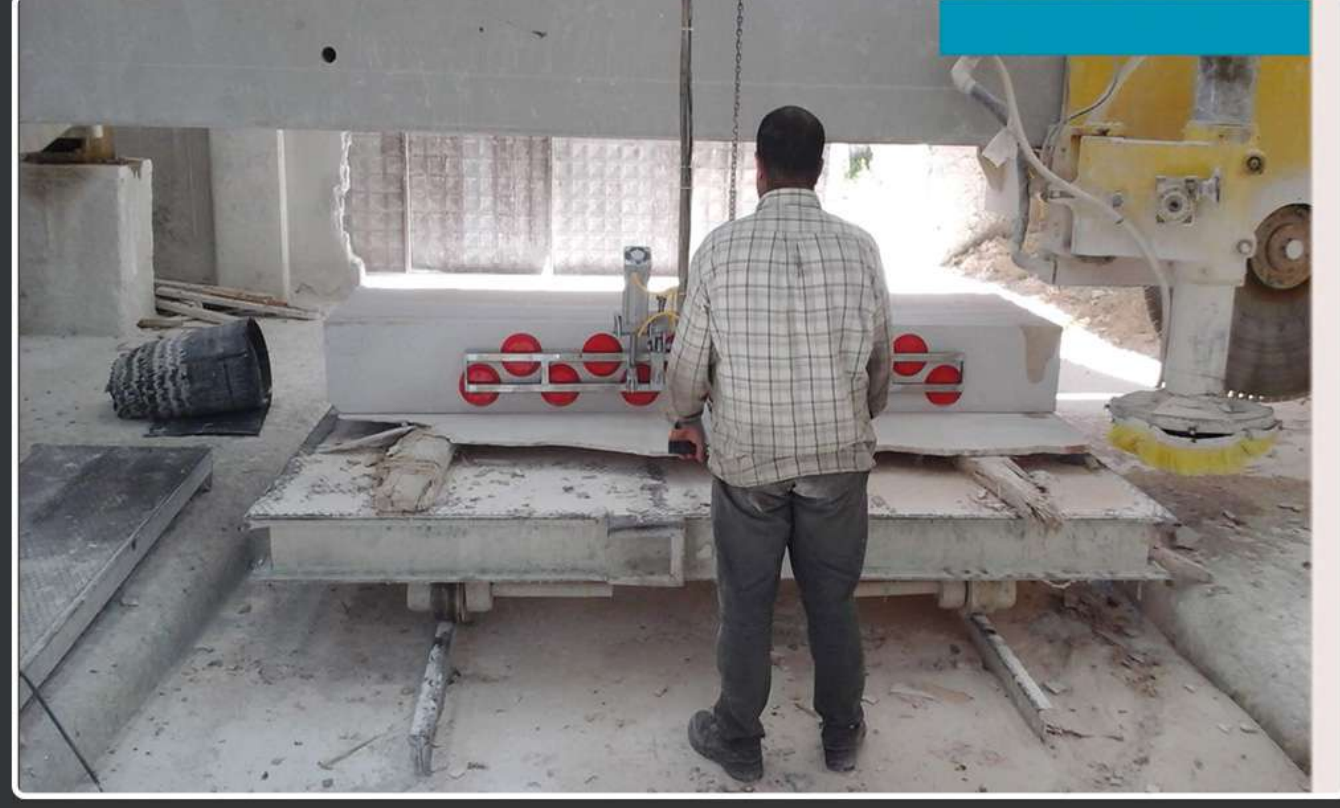
ST'ler için vakumlama sistemi Kaldırma kapasitesi: 500 kg Maximum boy 3000 mm Maximum en 650 mm
